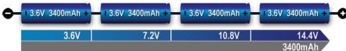
Figure 28 : Mise en série de cellules [85]
