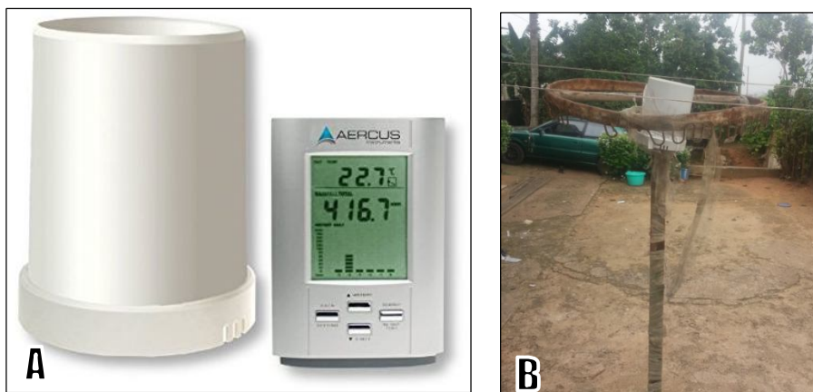
Photo 2: Aperçu du pluviomètre AERCUS (A) et installation dans le bassin versant (B)
