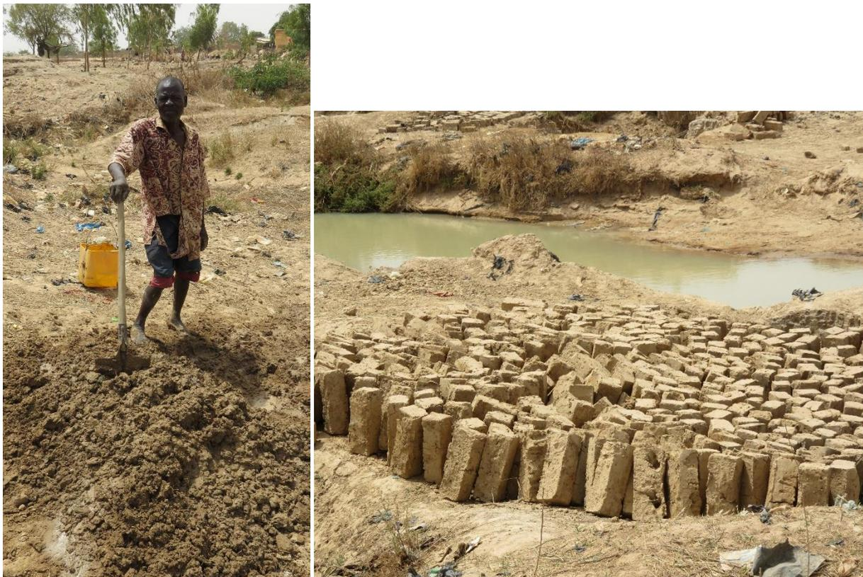
Photo 1 : Fabrication artisanale de briques en banco. Source : Sacha Bronfort (2017)
