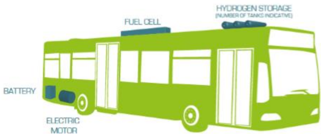
Figure 2 : représentation schématique d'un FC bus
