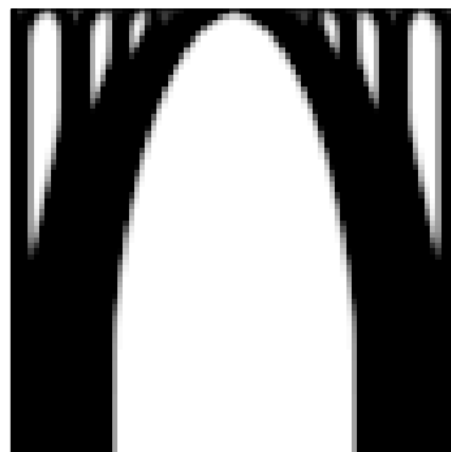
FIGURE 3.13 – Cas 4 avec critère d'arrêt sur f_0 et en entrée : n_x = n_y = 80 , \text{volfrac} = 0.5 , \text{penal} = 3 et \text{rmin} = 1.6
