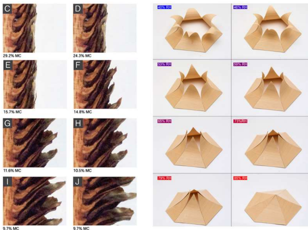
Figure 64 : HygroSkin - Degrés d'ouverture fonction de l'humidité relative - Cône du conifère (gauche) - Cavité (droite) tiré de Reichert & al., 2015, p.52
