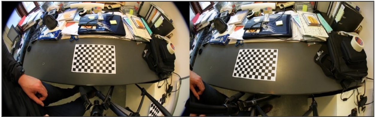
Figure 7 : Test de calibration pour l'orientation relative du système à stéréovision
