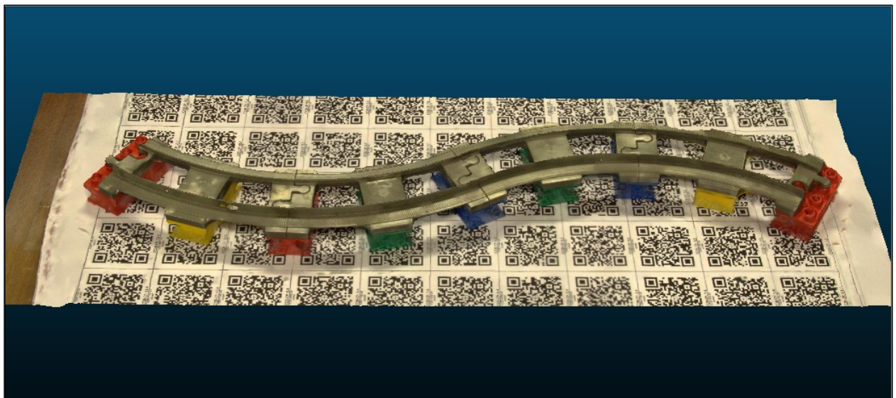
Figure 30 : Modèle 3D géoréférencé à l'aide de QR Codes
