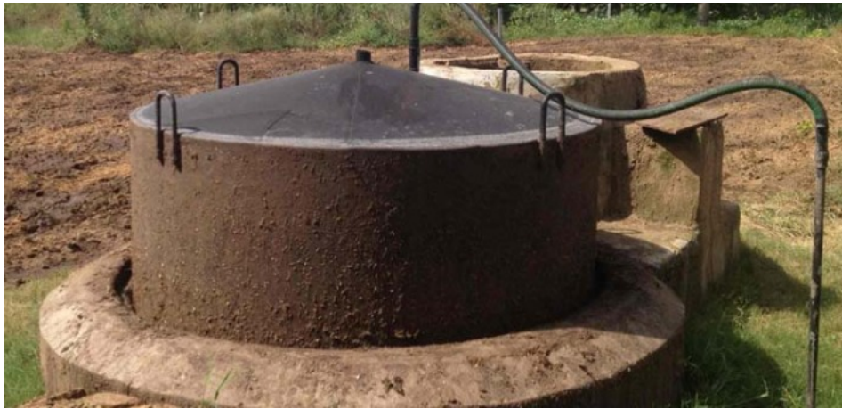
FIGURE 6 – Digesteur à biogaz utilisé pour la fermentation anaérobie [14]
