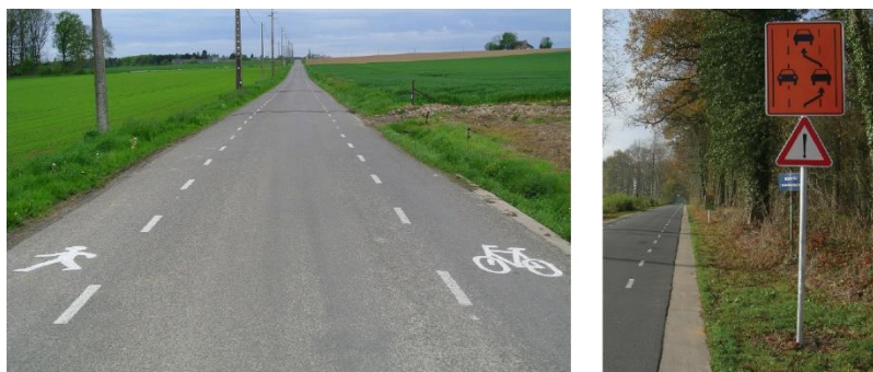
Figure 47: Configuration d'une chaussée à voie centrale banalisée.
