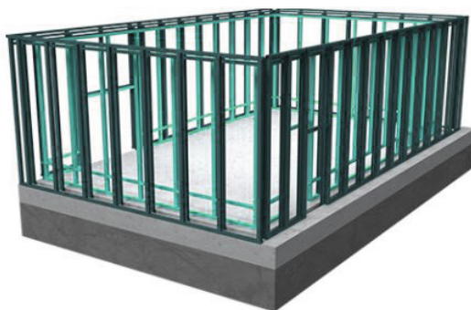
Fig 119 : Indépendance structurelle des laboratoires
