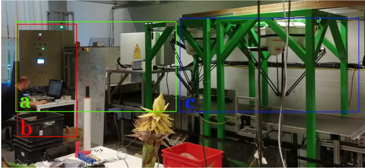
FIGURE 3.1 – Disposition du prototype Pick-It. (a) Éléments de caractérisation (b) Éléments de contrôle (c) Éléments de tri.
