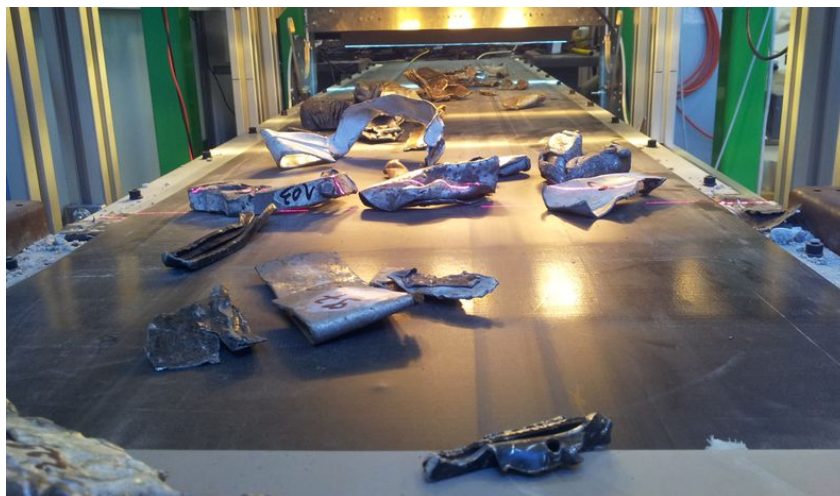
FIGURE 2.3 – Déchets métalliques en cours de tri sur la bande convoyeuse du prototype du projet Pick-It.
