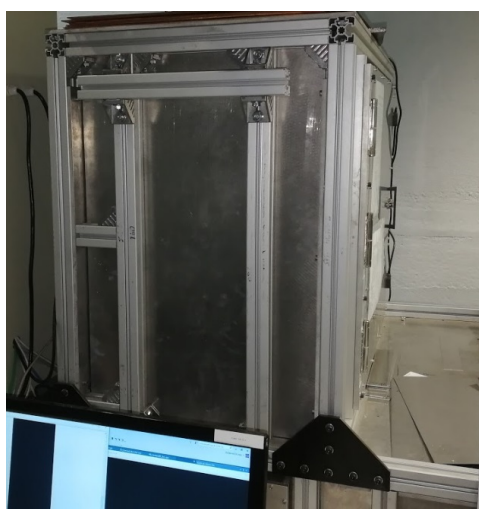
FIGURE 3.5 – Caisson à l'intérieur duquel s'effectue l'analyse par rayons X.
