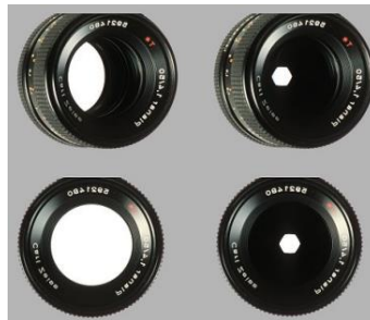
Figure 19 : Représentation du blocage de l'éclairage oblique en fonction de l'ouverture de l'objectif. A gauche, l'objectif est ouvert en grand. En haut à gauche, l'ouverture de l'objectif n'est pas entièrement visible par le côté.
