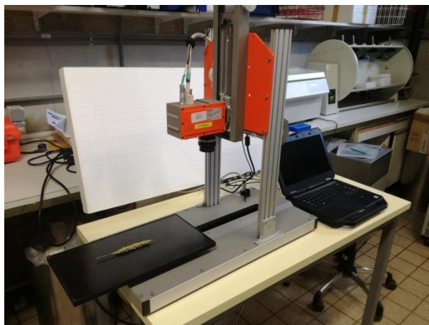
Figure 16 : Dispositif fixe de la caméra Specim FX17 avec la caméra, le tapis roulant et l'ordinateur qui contrôle le tout.
