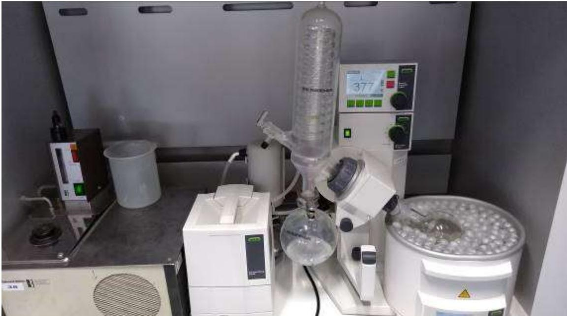
**Figure 15 :** Evaporateur rotatif en fonction (Fagbohoun, 2018)
