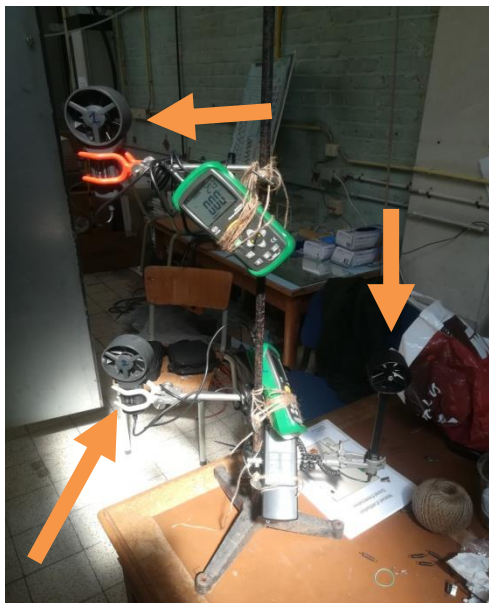
Figure 11: Photographie du dispositif avec lequel les mesures ont été effectuées. Les flèches orange indiquent où étaient placées les sondes à hélices des anémomètres.
