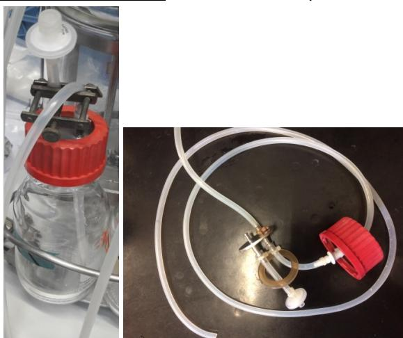
Figure 41: bouteille d'acide à gauche et montage à l'intérieur à droite
