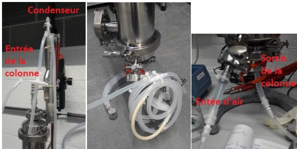
Figure 36: Tuyau en silicone de la colonne
