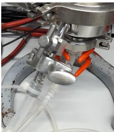
Figure 56: Vanne d'aération de la colonne
