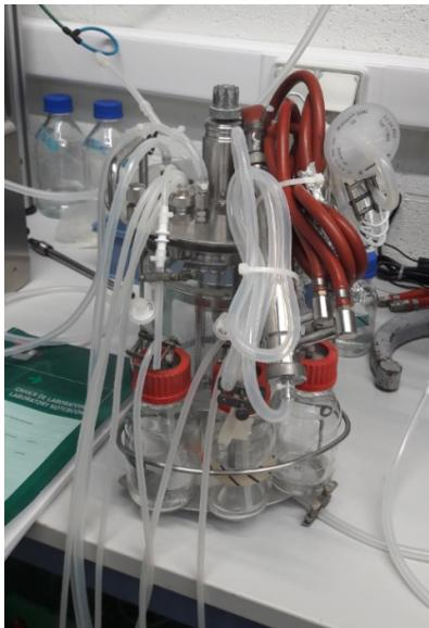
Figure 44: réacteur prêt avant l'autoclave
