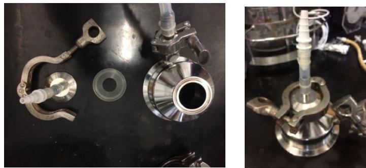
Figure 30: Matériel du bas de la colonne (gauche) et assemblage du bas de la colonne (droite) (Illustration du travail de Bachelor de Clément Furrer)
