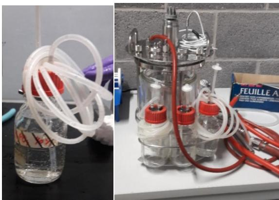
Figure 59: bouteille de base (gauche) et bouteille sur réacteur (droite)
