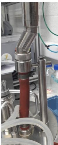
Figure 40: Condenseur du réacteur
