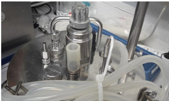
**Figure 39: Couvercle du réacteur avec sonde pO<sub>2</sub> et tuyau d'aération**
