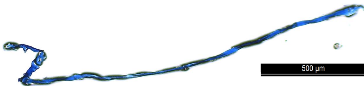
Figure 26. Fibre bleue isolée de la matrice de boue, vraisemblablement en coton (No 9)
