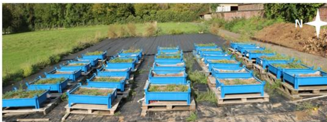
Figure 4 : Photographie du dispositif en bacs expérimentaux testant deux modalités de substrat (Substrat léger pour toiture verte Extensif Zinco® et le Substrat léger pour toiture verte Lavandulis Zinco®) et trois modalités de profondeur (5, 10 et 15 cm).
