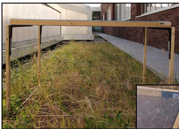
Figure 10 : Dispositif perforé utilisé pour évaluer le couvert relatif sur base de la méthode de point quadrat.
