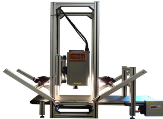
Figure 17: Caméra line scan hyperspectrale proche infrarouge (BurgerMetrics SIA, Riga, Lettonie)
