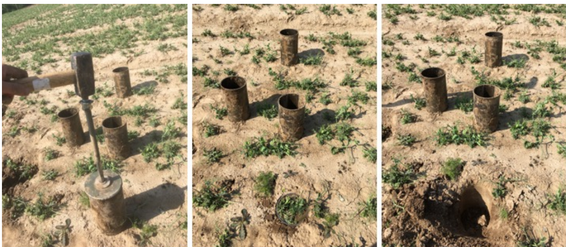
Figure 13 : Illustration du prélèvement des carottes de sol avec le système racinaire de pois au moyen de tubes en PVC.
