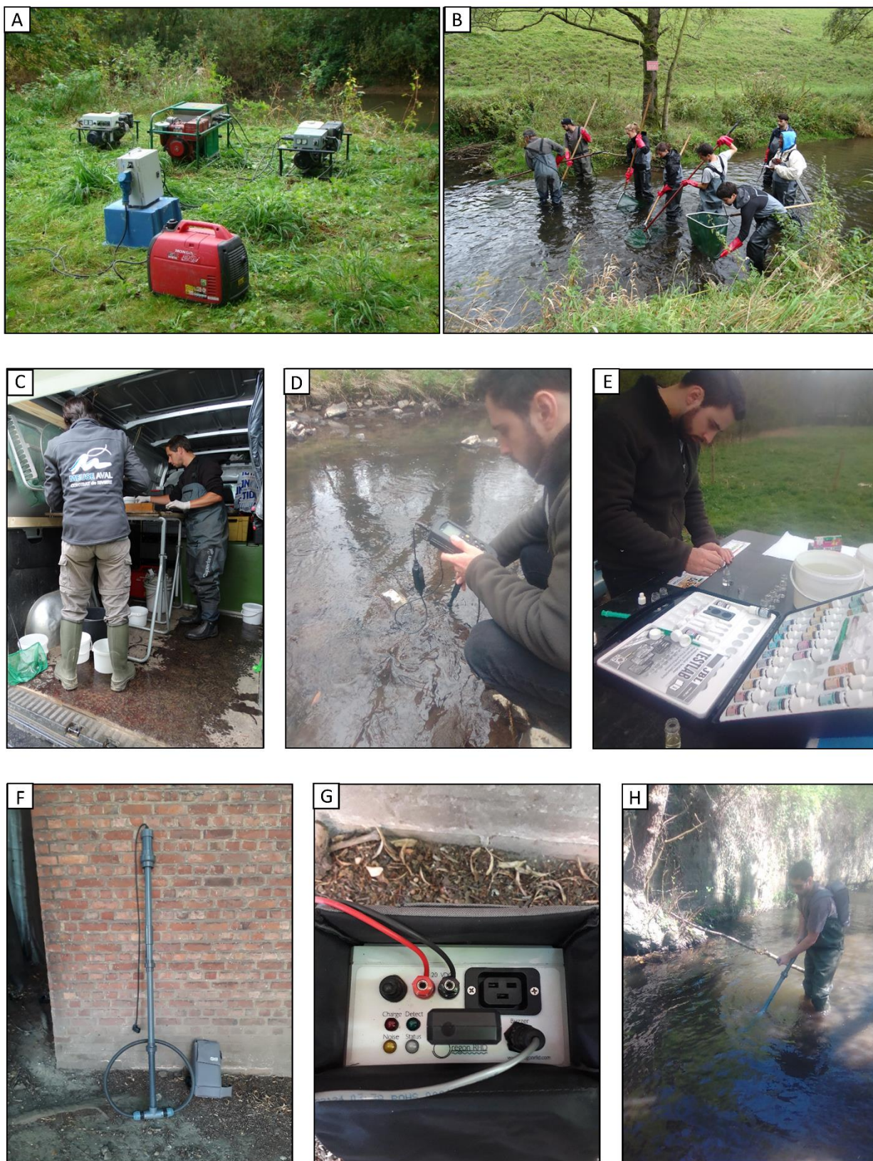
Figure 16: A : Groupes électrogènes placés pour une pêche électrique ; B : Pêche électrique de capture d'anguillettes ; C : Mesures biométriques des anguillettes capturées ; D : Mesure physico-chimique avec un appareil électronique de mesures multiples Hach HQ30D ; E : Analyses Figure physico-chimiques par colorimétrie ; F : Antenne et boîtier électronique de télémétrie mobile RDIF ; G : Vue supérieure du boîtier électronique ; H : Utilisation du matériel de télémétrie mobile RFID.
