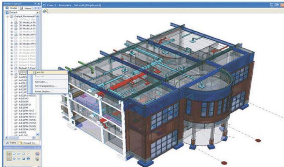
Figure 24. Détection d'interférences avec Bentley Navigator.
