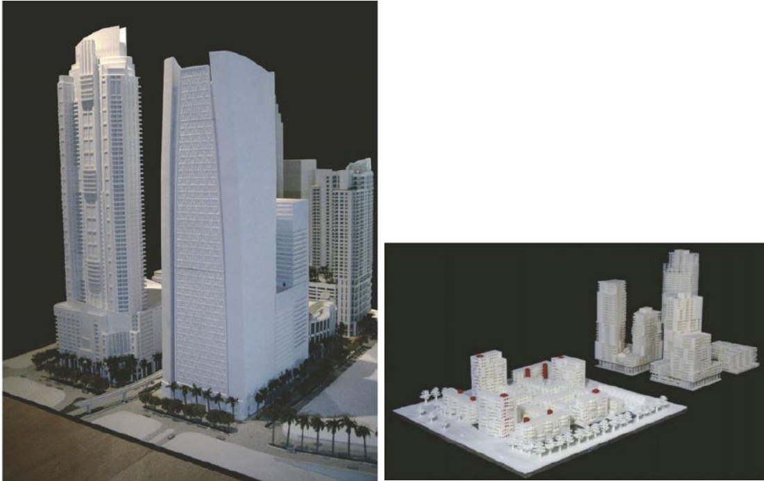
Figure 27. Impression 3D réalisée en moins de temps et pour le quart du prix des maquettes classiques (Source : The Realization Group).
