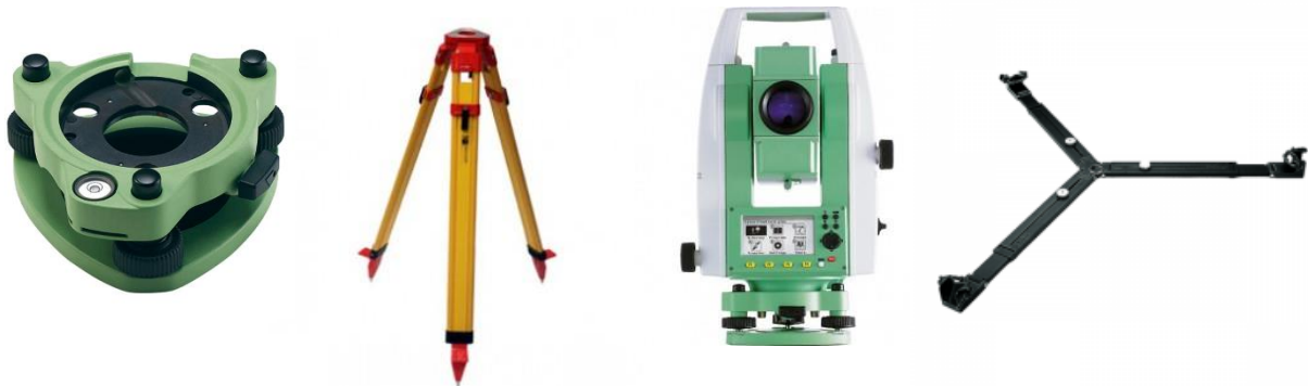
Figure 45 : Matériel à disposition pour le levé topographique. De gauche à droite : embase, trépied, station totale, araignée
