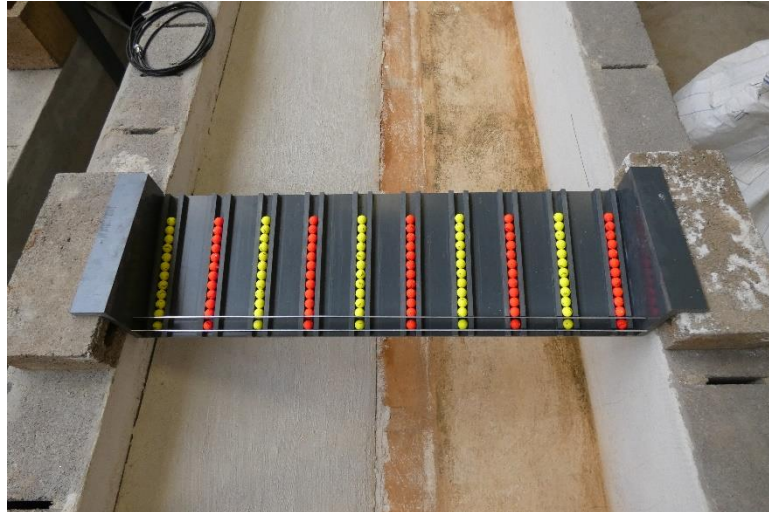
Figure 5 : Dispositif pour lâcher les flotteurs
