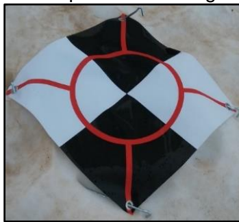
Figure 35 : Cible de validation ancrée dans la neige par des piquets de tente
