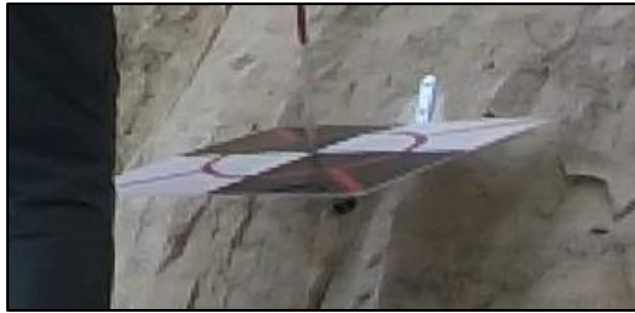
Figure 34 : Cible rigide forée à la roche à l'aide d'une équerre de 30 - 60°
