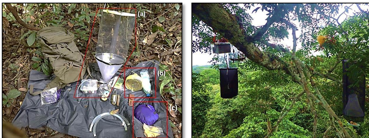
Figure 10: A gauche, les constituants nécessaires au montage des pièges avant leur installation dans la canopée, (a) Le piège lumineux à plaque transparente (structure plaques d'interception/entonnoir – batterie 12 V reliée à la source lumineuses LEDS – filet du sac de récolte), (b) Piège jaune (réceptacle jaune - eau savonneuse), (c) Piège à papillons (filet replié – appâts fermentés). A droite : les trois dispositifs placés dans la canopée. (© Arnaud Segers)
