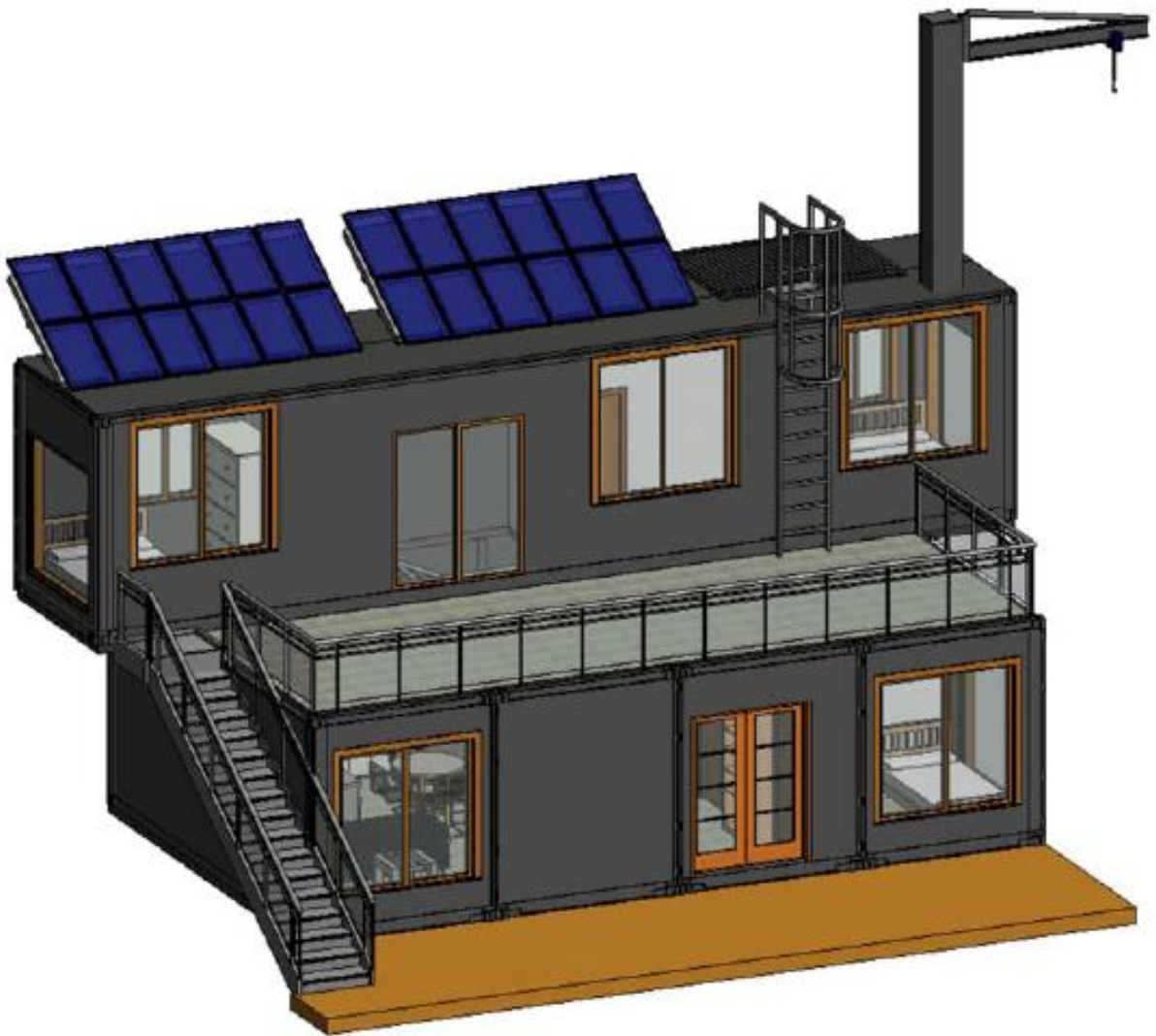
Figure 16 : Modèle 3D de la maison container passive (Bowley, & Mukhopadhyaya, 2017)
