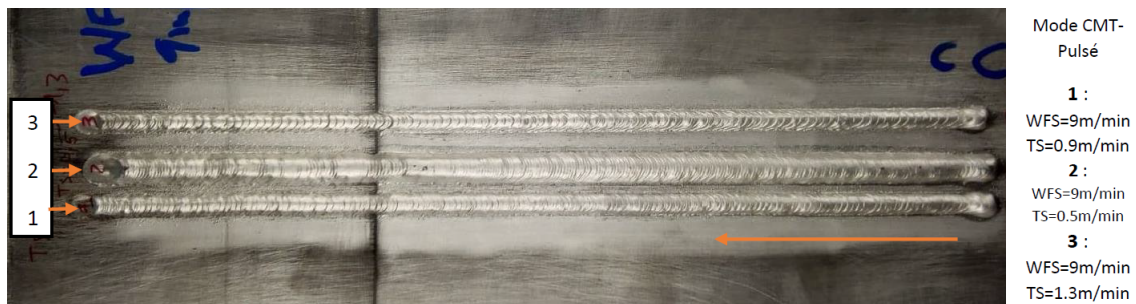
FIGURE 2.5 – Monocouches réalisées avec le procédé CMT pulsé
