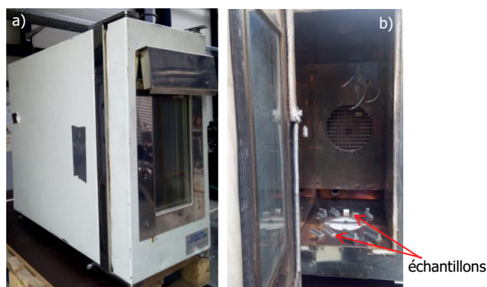
FIGURE 2.17 – Four utilisé : a) Vue générale du four, b) Échantillons WAAM placés dans le four
