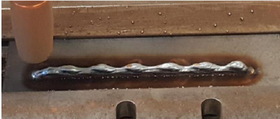
FIGURE 1.15 – Phénomène de humping [Bodocco, 2018]
