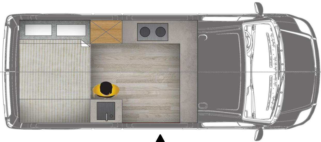
**Figure 49 : Plan d'aménagement de Renault Master L2H2 (Configuration de nuit)**
