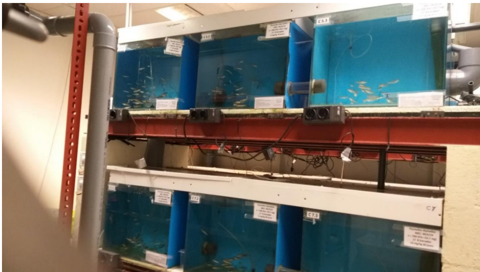
Figure 5 : circuit expérimental d'aquarium de 50 litres alimentés en eau de puit à 15°C en circuit ouvert.
