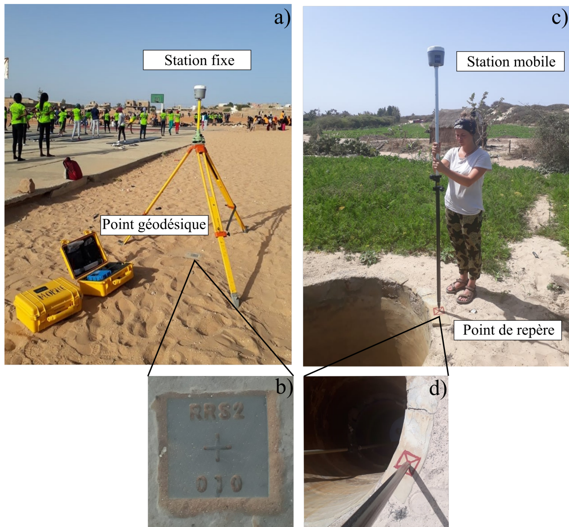
FIGURE 8 – Nivellement au GPS différentiel lors de la campagne de terrain de mars 2019 dans les communes de Darou Khoudoss, Taïba Ndiaye et Méouane ; avec en a) la station GPS fixe de référence localisée précisément sur le point géodésique RRS2 030 (agrandissement en (b)) ; et en c) la station GPS mobile localisée sur un point de repère (agrandissement en (d)).
