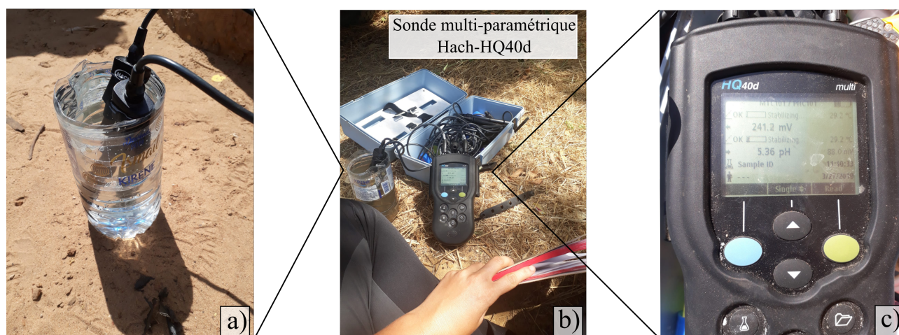
FIGURE 9 – Mesure des paramètres physico-chimiques avec la sonde mutli-paramétrique Hach-HQ40d; avec en a) deux sondes (parmis les 4) permettant de mesurer les paramètres physico-chimiques disposée dans l'échantillon d'eau du puits à analyser; en b) l'ensemble de l'appareil, les sondes et le dispositif de prise de mesures et en c) le dispositif de mesure, avec les valeurs des paramètres physico-chimiques s'affichant sur le cadran. Photos prises lors de la campagne de mars 2019 sur la zone d'étude.
