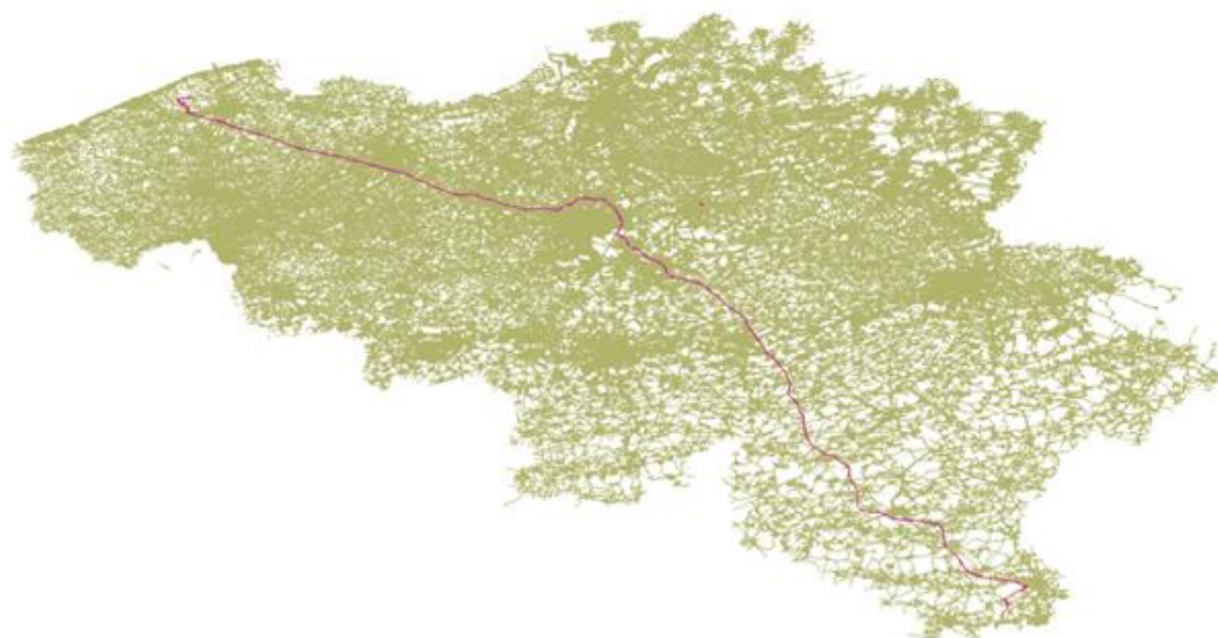
Figure 34 : Trajet résultant du plus court chemin entre deux nouveaux nœuds insérés dans le graphe (Annexe 1)
