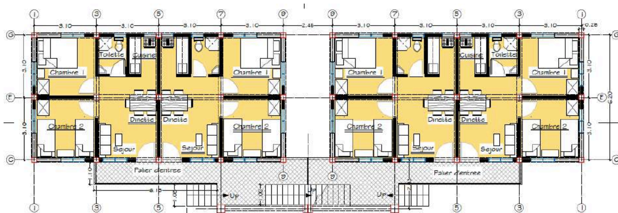
Plan 10: Plan du rez-de-chaussée de l'immeuble 2. Source : Plan d'exécution Nazon Sud – Union 1B, de janvier 2014. Document remis par la BMPAD.
