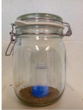
Figure 11: Respiromètre comportant du sol et une fiole de NaOH
