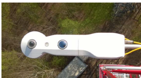
FIGURE 12 – Illustration du pyradiomètre, constitué d'un pyranomètre (rayonnement solaire) et d'un pyrgéomètre (rayonnement IRL), de la forêt de Hesse (Greiveldinger, 2016).
