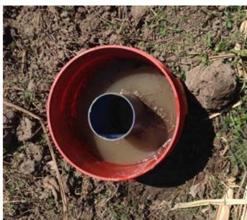
**Figure 13.** Dispositif expérimental de la méthode Muntz ou double anneaux.
