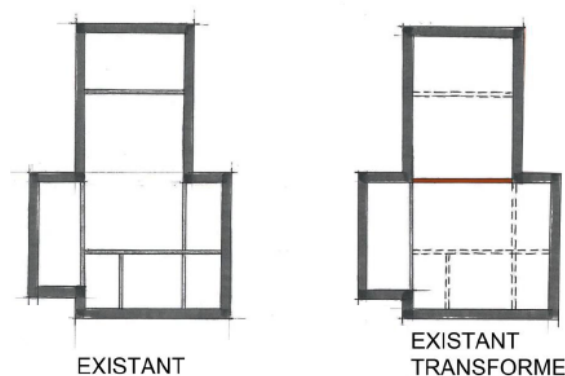
FIGURE 24 – Principe de l'évolutivité intérieure [XB Architectes, 2015]
