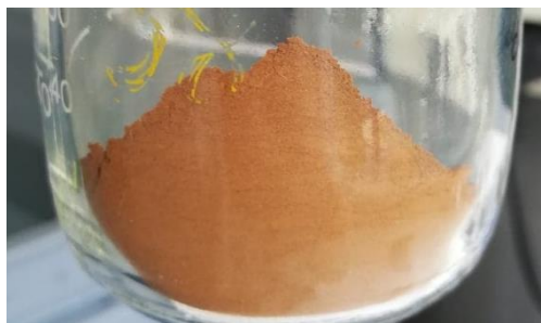
Figure 12. Poudre de goethite obtenue par le premier protocole de production
