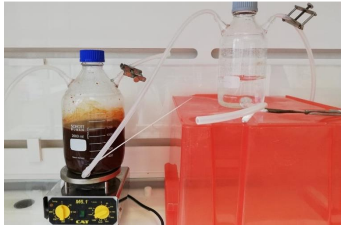
Figure 11. Dispositif sous atmosphère contrôlée utilisé lors du deuxième protocole de production
