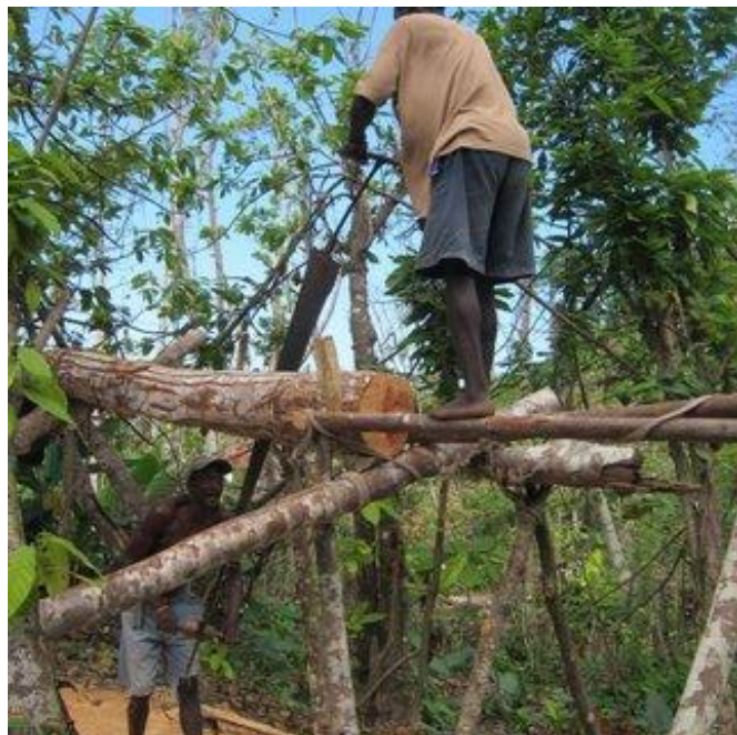
Figure 12 : Technique de fabrication de planche
