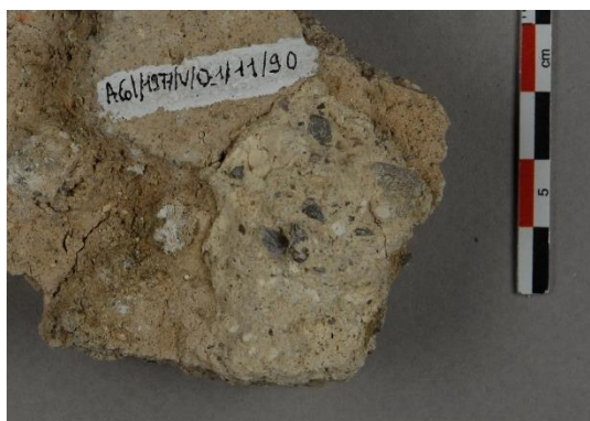
Fig. 55 – Couche inférieure d'enduit de type D3
