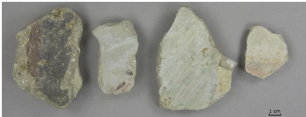
Fig. 31 – De gauche à droite : application de la couche picturale directement sur l'enduit, application d'une couche préparatoire blanche plus ou moins épaisse
