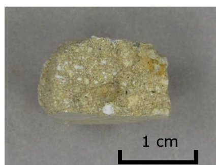
Fig. 28 – enduit de type A2
