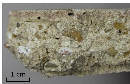
Fig. 69 – Les différentes couches d'enduit du fragment 49/1
