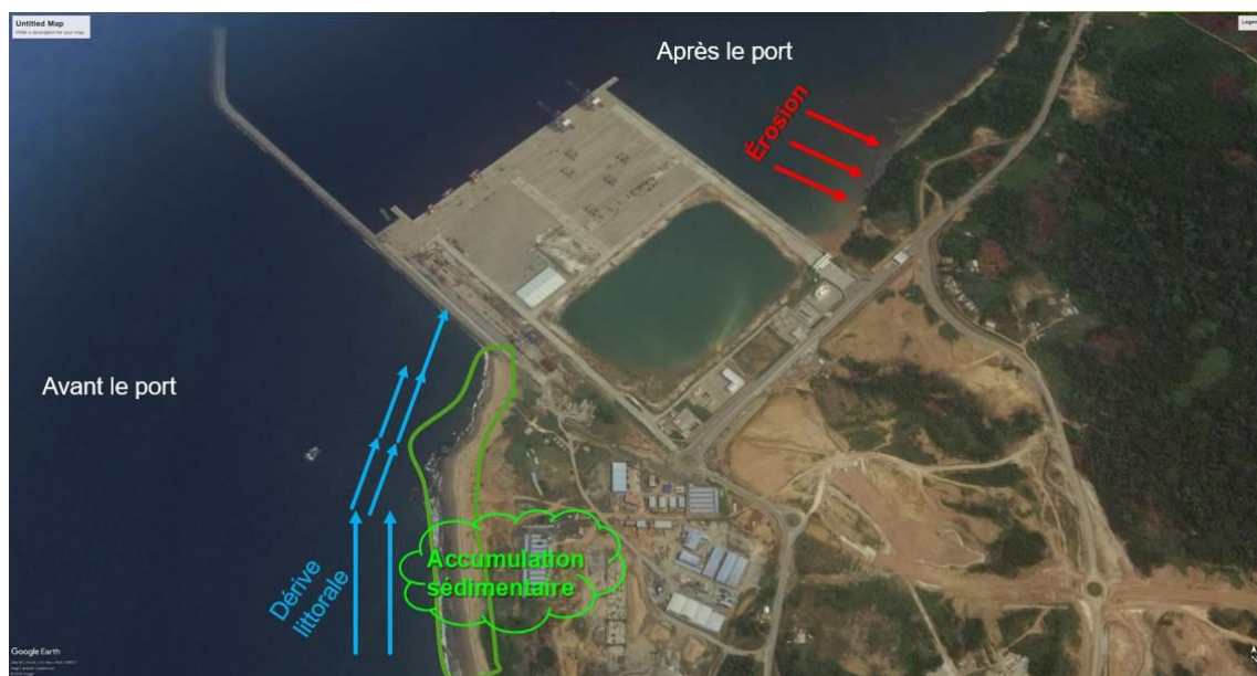
Figure 20 : Image Google Earth du PAK en 2017 montrant un engraissement en amont du port et un démaigrissement en aval.
