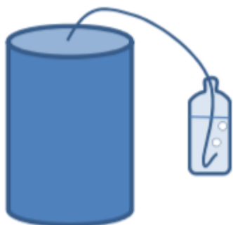
Figure 1: Système d'échappement du gaz (Dorian,2015)
