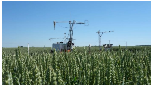
Figure 1 – Station de mesure de la covariance de turbulence installée à Lonzée
