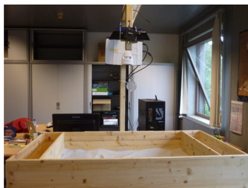
Figure 7 : Exemple d'un dispositif de projector-Display. Il s'agit sur l'illustration d'un bac à sable en réalité augmentée (Vivegnis, 2017)
