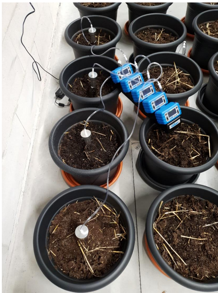
Figure 25. Dispositif de prélèvement des odeurs avec les sondes reliées aux pompes à air créant un flux d'air de 170ml/min.
