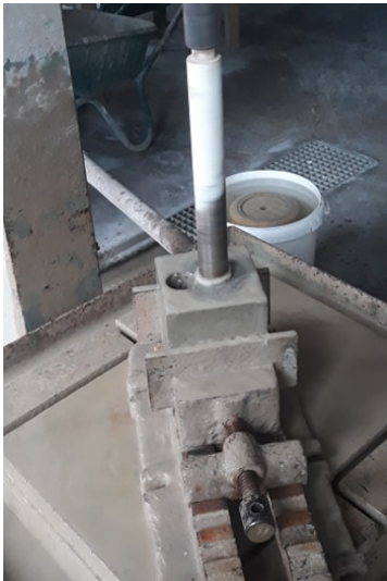
FIGURE 16 – Réalisation de cylindres de béton à l'aide d'une carotteuse
