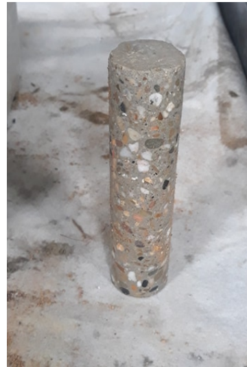
FIGURE 17 – Carotte obtenue après carottage
