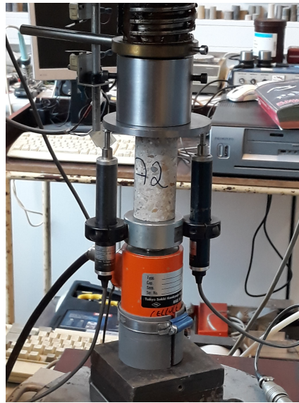
FIGURE 22 – Dispositif du test de compression cyclique
