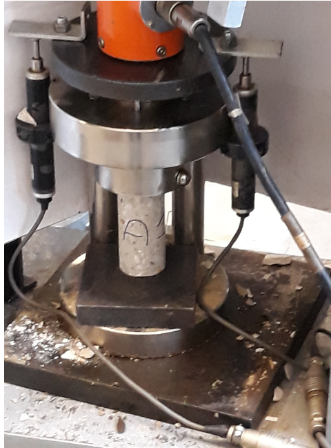
FIGURE 21 – Dispositif du test de compression simple
