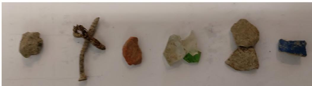
FIGURE 2.5 – Matériaux constitutifs des M.I.O.M utilisés au laboratoire.
