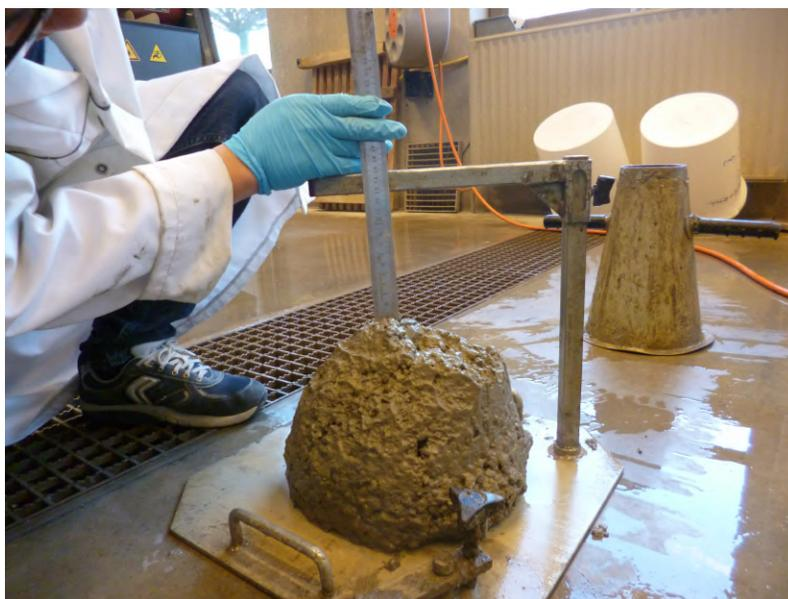
FIGURE 7.1 – Mesure de l’affaissement via le cône d’Abrams pour le BL G100 S0.
