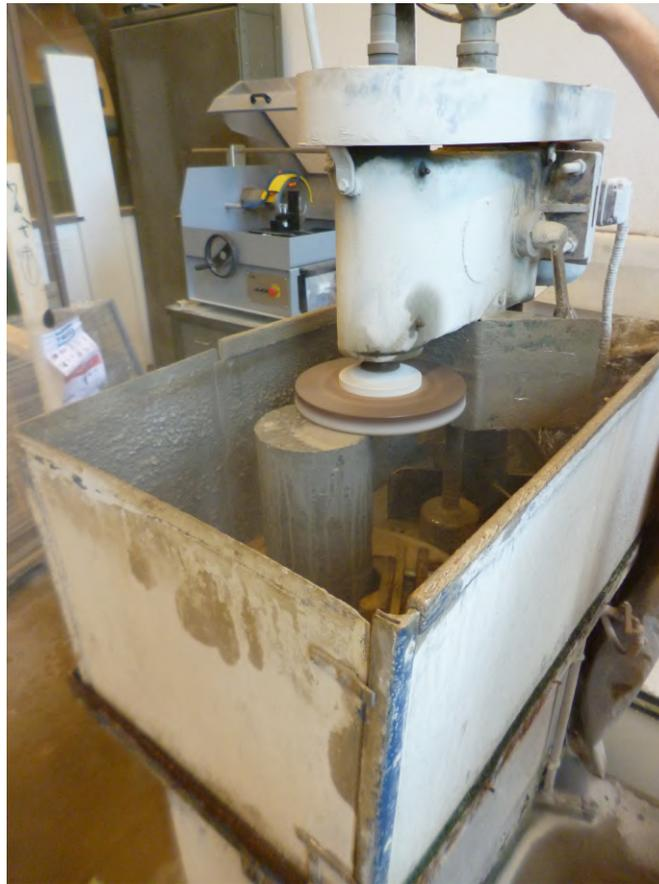
FIGURE 7.3 – Polissage des surfaces pour un cylindre de 160x320mm.
