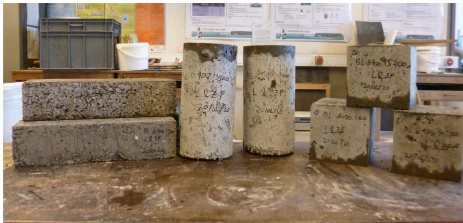
FIGURE 8.6 – Ensemble des échantillons pour la composition BL G100 S100.
