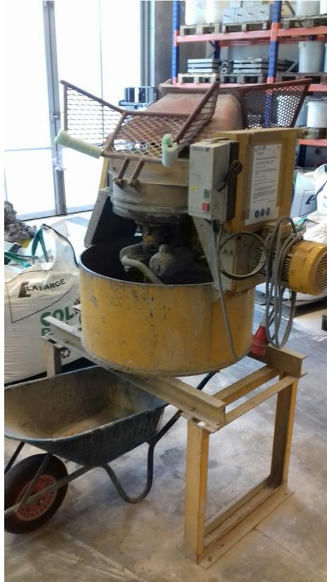
FIGURE 6.2 – Bétonneuse utilisée au laboratoire de l'université de Liège pour réaliser de gros volumes.
