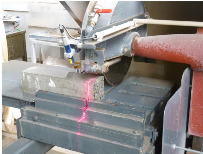
FIGURE 7.6 – Sciage d'une tranche d'un échantillon BL G100 S0.
