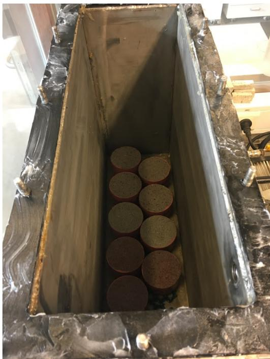
(a) Mise en place des échantillons dans la chambre sous vide.
