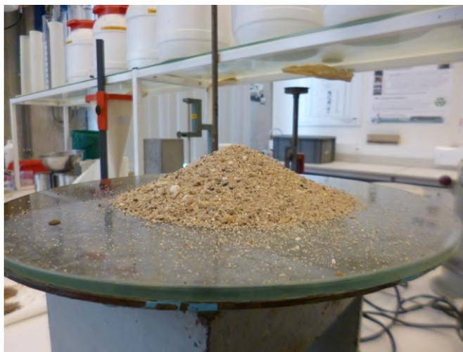
FIGURE 5.1 – Sable naturel 0-4 mm saturé à surface sèche.
