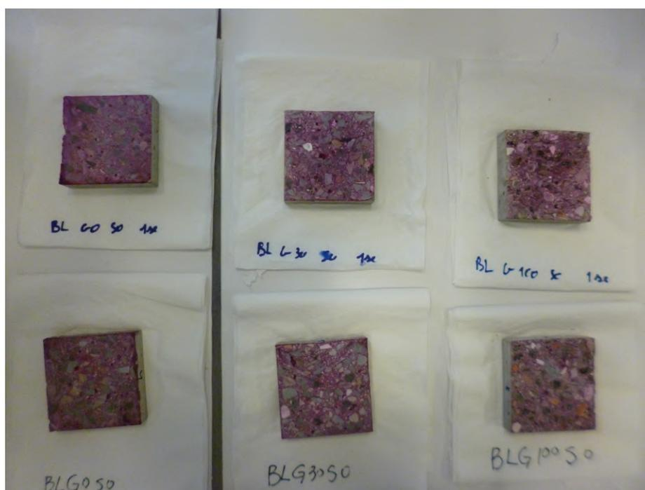
FIGURE 7.8 – Illustration du front de carbonatation au temps zéro et après une semaine pour BL G0 S0, BL G30 S0 et BL G100 S0.
