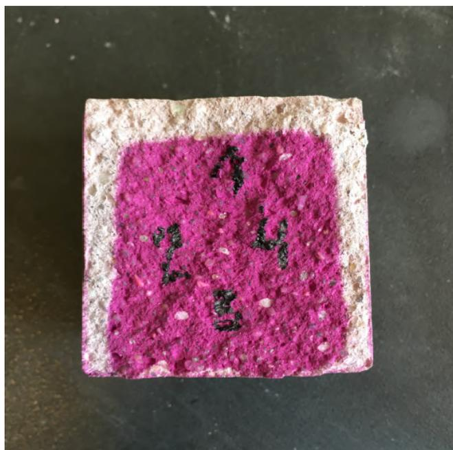
FIGURE 7.7 – Exemple de numérotation à réaliser lors des essais de carbonatation [Wintgens, 2019].
