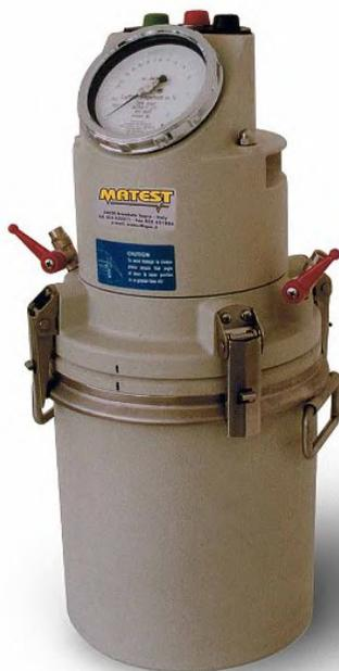
FIGURE 7.2 – Aéromètre : appareil de mesure pour la teneur en air.
