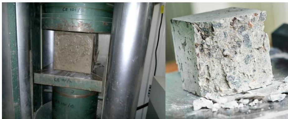
FIGURE 7.4 – Essai de compression réalisé sur un cube de 150mm de côté [Canteneur, ].
