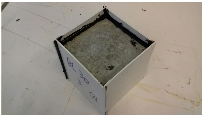
FIGURE 7.13 – Illustration d'un coffrage fait de plaques en plastique dur et une membrane en polyéthylène.
