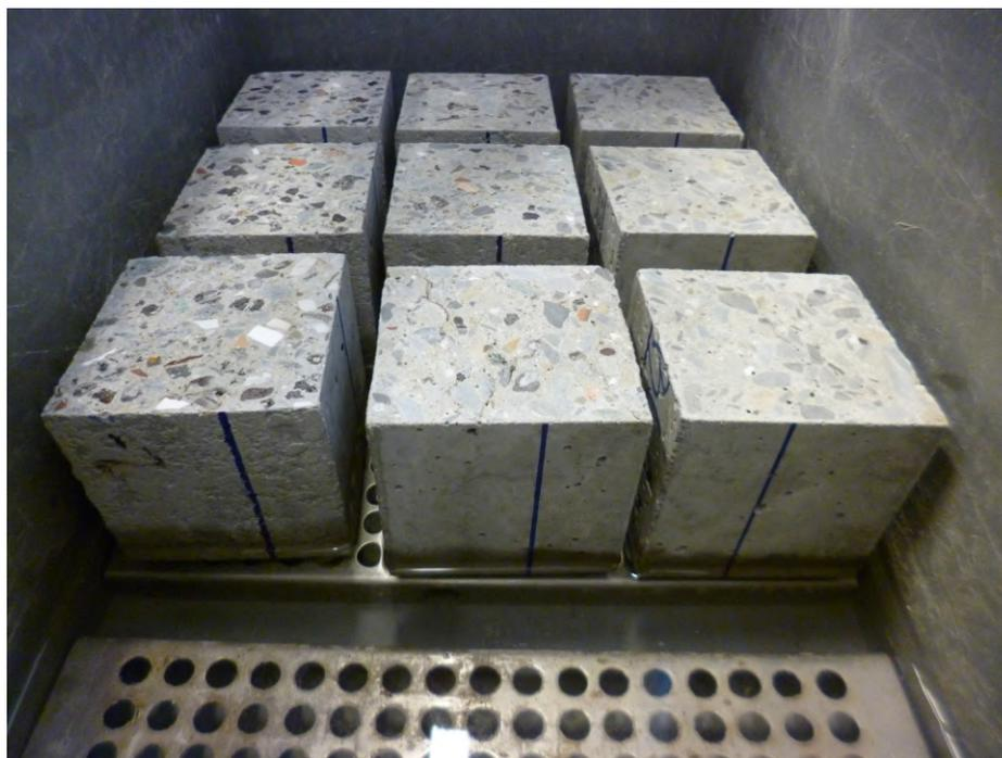
FIGURE 7.5 – Absorption par remontée capillaire de BL G100 S0, BL G30 S0 et BL G0 S0, respectivement de gauche à droite.
