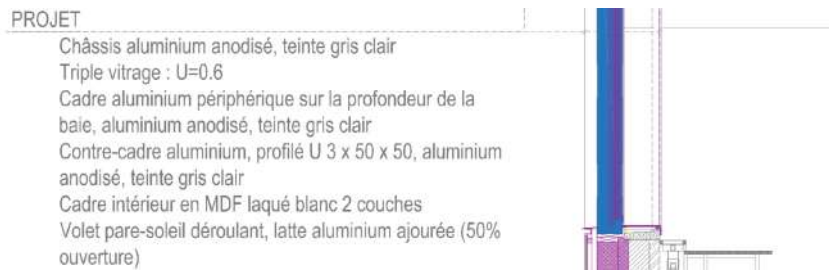
Figure 28 - Rénovation des châssis (Administration des ressources Immobilières, 2016)
