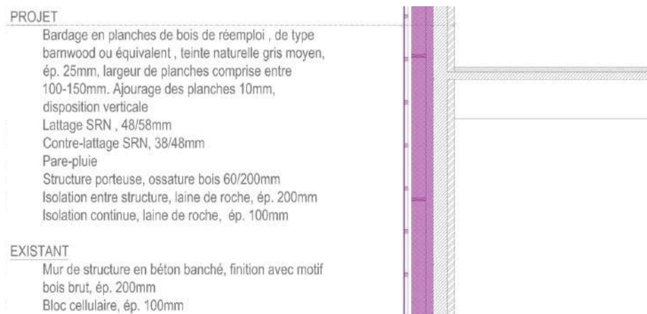
Figure 26 - Rénovation des parois verticales des niveaux +1 à +3 (Administration des ressources Immobilières, 2016)
