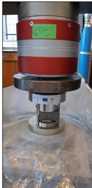
FIGURE 48 – Essai de compression sur le mortier durci
