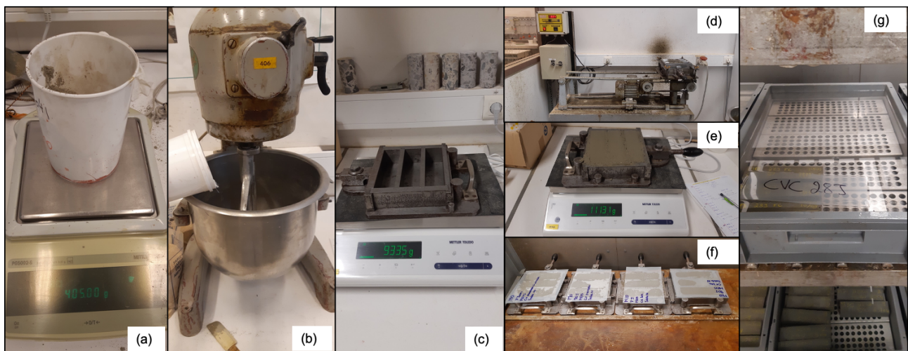
FIGURE 43 – Étapes de réalisation des échantillons de mortier
