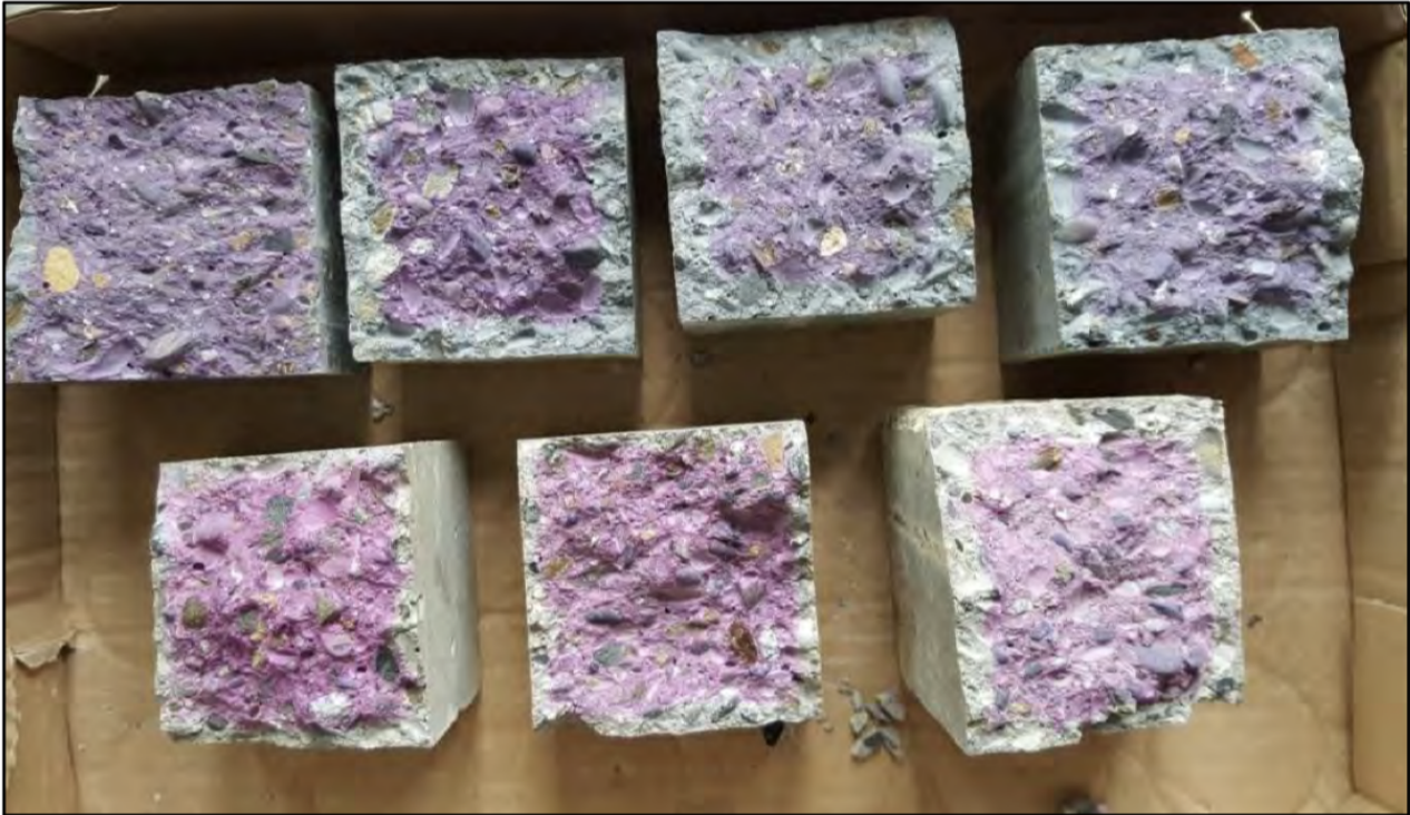
FIGURE 24 – Carbonatation des éprouvettes après pulvérisation à la phénolphthaléine [Sow, 2016]
