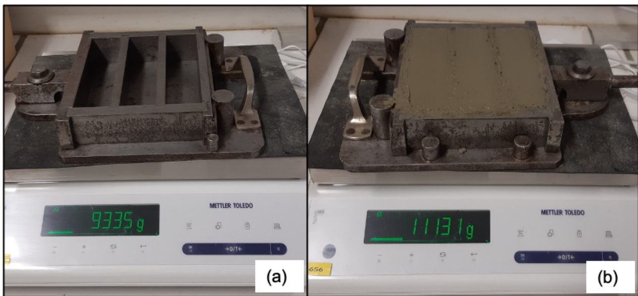
FIGURE 46 – Étapes de mesure de la masse volumique du mortier à l'état frais
