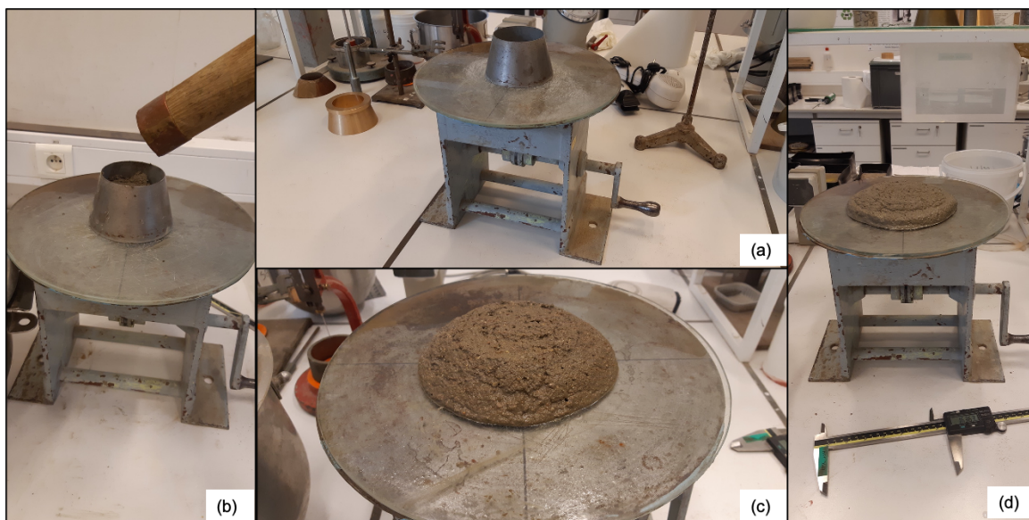
FIGURE 45 – Étapes de réalisation du test au mini-cône
