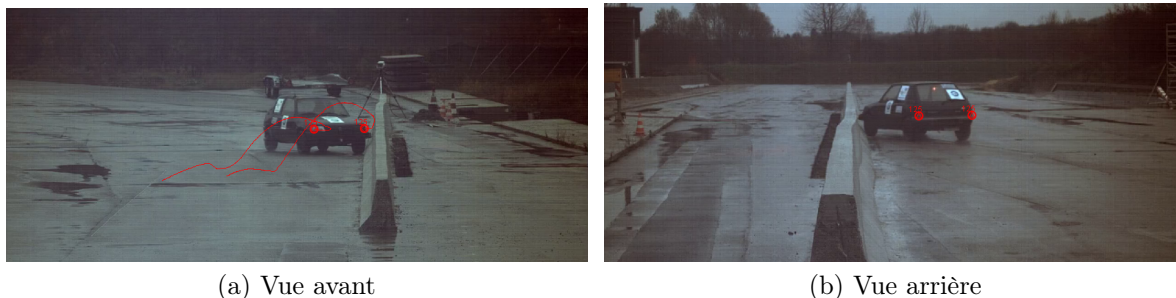
FIGURE 5.6 – Illustrations des points du véhicule repérés sur les vues avant et arrière du crash contre la barrière Linetech.
