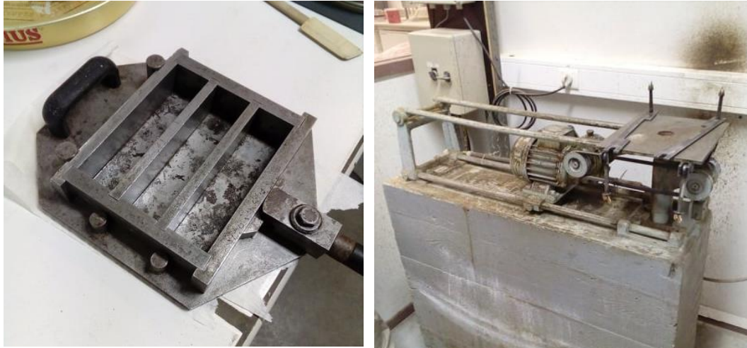
Figure 41 : Photos des moules utilisés et de la table à secousses.
