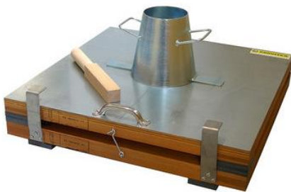
Figure 18 : Matériel utilisé pour l'essai d'étalement et classes de consistances.
