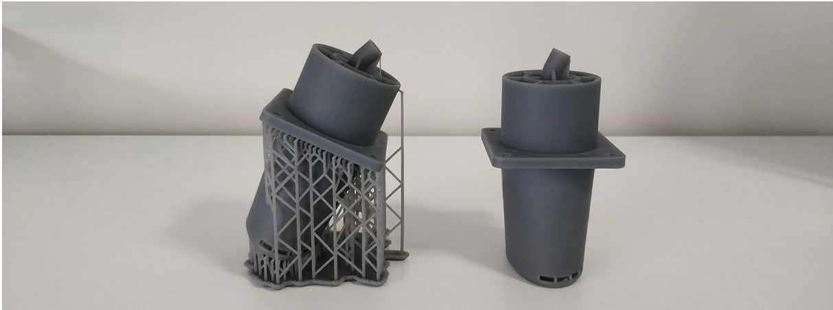
Figure 3 : Résultat d'une impression 3D avant et après la phase de finition.
