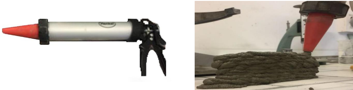
Figure 27 : Illustration du pistolet utilisé et du test réalisé.
