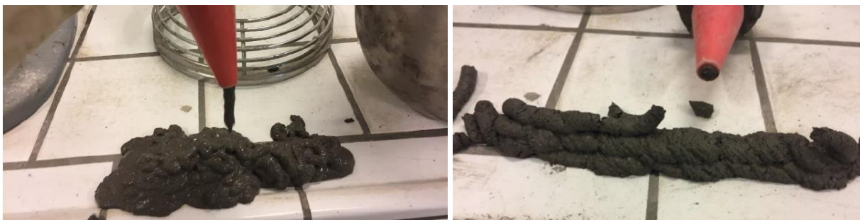
Figure 28 : Tests négatifs montrant un matériau cimentaire bouchant le pistolet et un autre s'écoulant de lui-même.
