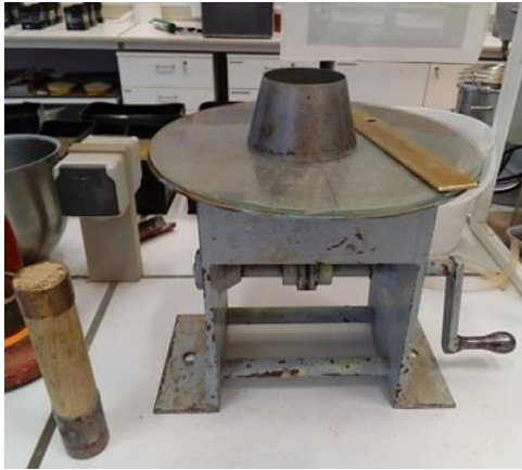
Figure 42 : Table à secousses et dimensions du dispositif tronconique.
