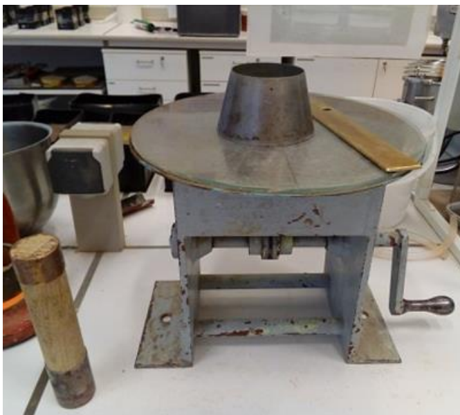
Figure 4: Dispositifs utilisés pour caractériser le mortier à l'état frais.
