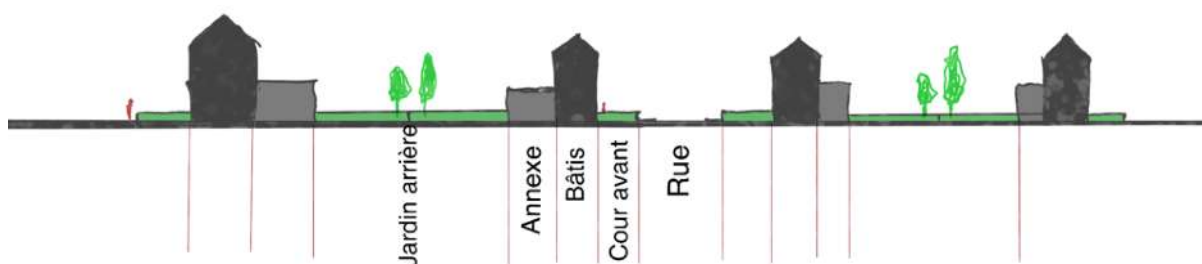
Coupe schématique de la configuration des cités-jardins Wauters à Herstal. ©Alexandre Houthoofdt
